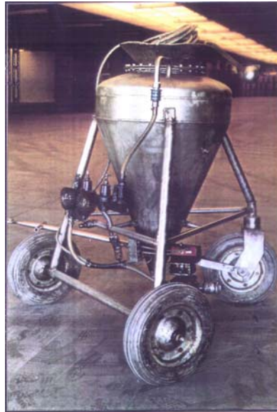
Figura 2. Cargadora neumática de anfo, sobre ruedas
