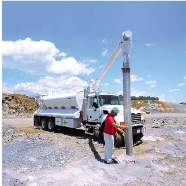
Figura 16. Camión Unibody cargando anfo
