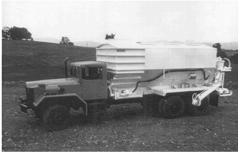
Figura 10. Camión para mezclado de anfo denso. El compartimento anterior del remolque contiene emulsión y el posterior anfo o nitrato amónico.
