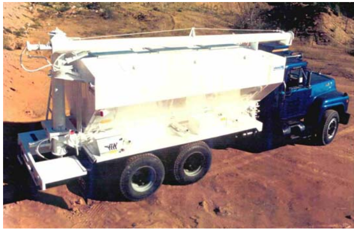
Figura 8. Camión de anfo con husillo de carga superior
